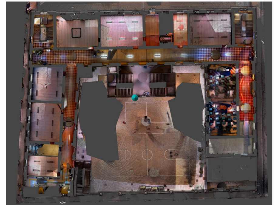
Nuvola di punti ottenuta da rilievo con Laser Scanner
